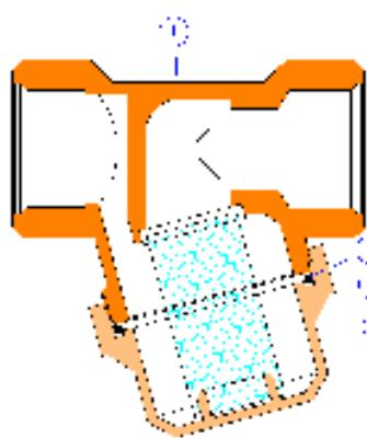
Фильтр состоит из корпуса 1, заглушкы 2, фильтроэлемента 3 и уплотнительного кольца 4. Корпус и заглушка фильтра выполнены из горячепрессованной латуни марки CW617N (ЛС59-2) с гальванопокрытием из никеля.
